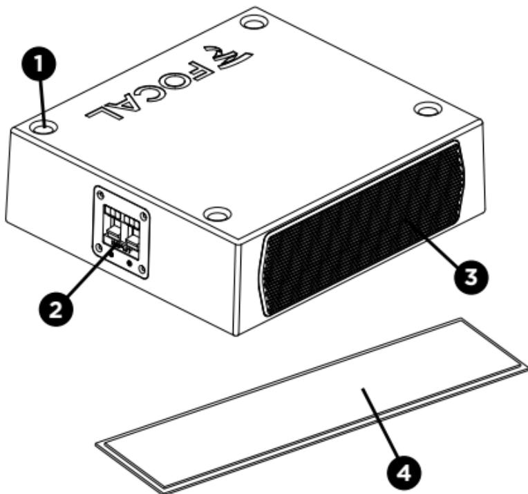
**1. Trou pour la fixation au plancher du véhicule :** Veillez à utiliser des vis adaptées afin de ne pas endommager le plancher de votre véhicule ou d'autres de ses composants.
