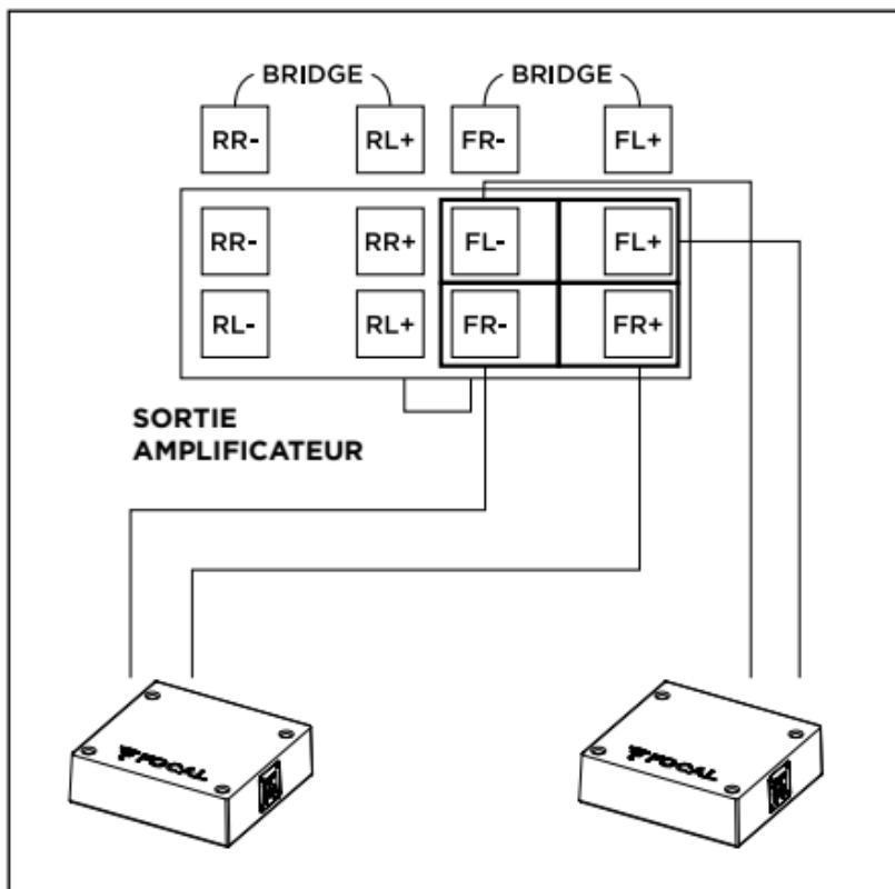
**ATTENTION :** Utilisez un canal indépendant non bridgé de votre amplificateur pour alimenter chaque subwoofer. Il est déconseillé d'opter pour un branchement en parallèle des deux subwoofers ou de les connecter sur une sortie bridgée, cela pourrait endommager l'amplificateur.
