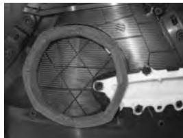
Laisser le joint mousse monté d'origine sur la garniture.
