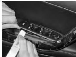
Utiliser ce même outil pour le démontage de la barre et la commande lève vitres.
