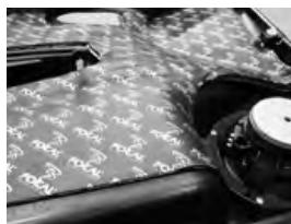
Une isolation acoustique est nécessaire afin de supprimer les vibrations dues à la fixation du haut-parleur sur la garniture (ref. B.A.M.).
