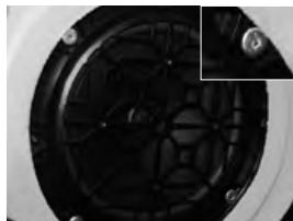
Opération de dérivetage à l'aide d'un forêt métal Ø 5,5 / 6 mm.
