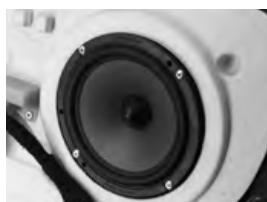
Procéder au rerivetage du haut-parleur FOCAL (rivet aluminium 4x16mm).
